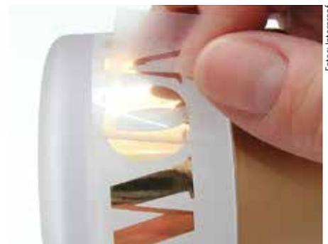
(3) Die Trägerfolie lässt sich jetzt leicht abheben und der Dummy ist bedruckt.
